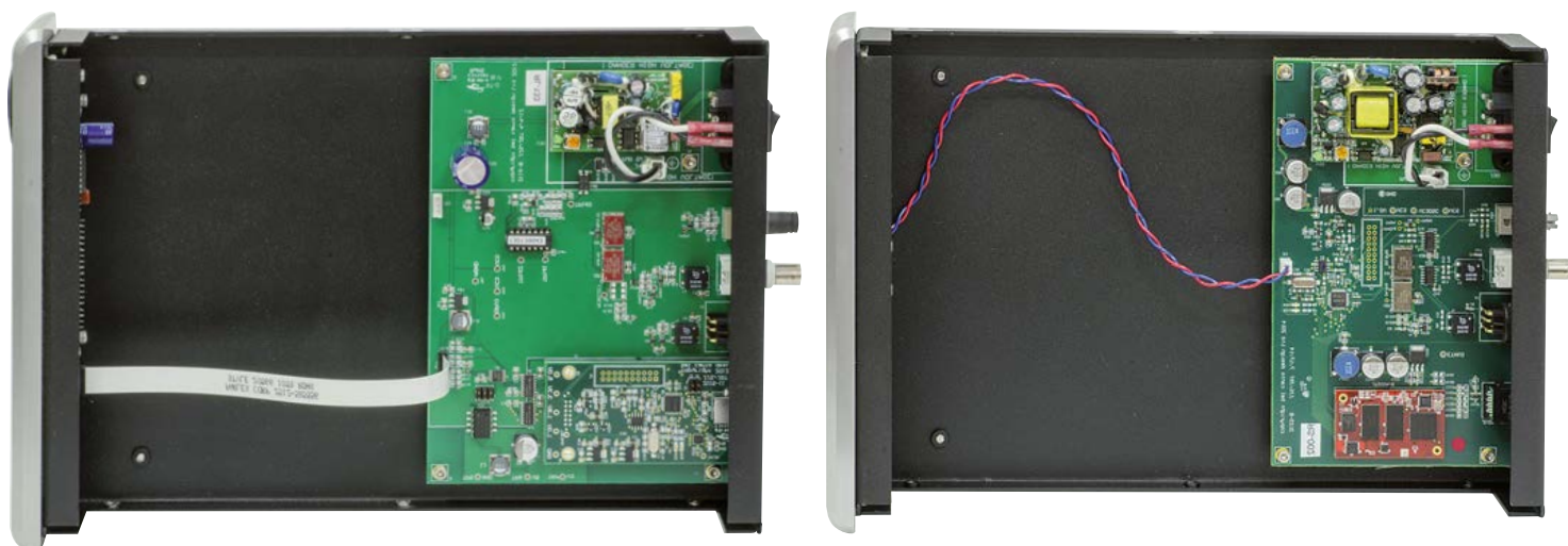
Il REFLink (a sinistra) e il REFStream (a destra) sembrano concettualmente molto simili pur presentando differenze nella realizzazione. I circuiti sono stati sviluppati su PCB sovrapposte che lasciano ampio spazio libero all'interno del telaio.
