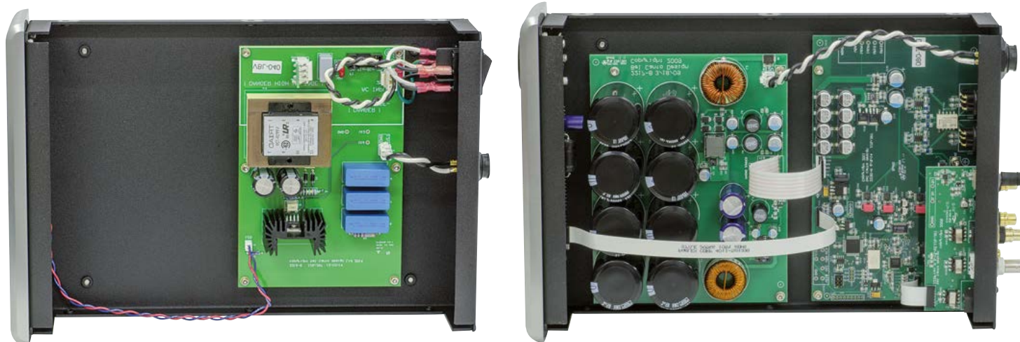
Il circuito di alimentazione del DAC 3.7 è diviso nei due telai che costituiscono la coppia inscindibile del sistema di conversione Bel Canto. All'interno del telaio VBL1 (a sinistra) è contenuta solo la sezione circuitale che tratta la corrente alternata di rete, raddrizzandola e stabilizzandola, mentre nell'unità di conversione è stata inserita la notevole sezione di filtraggio.
