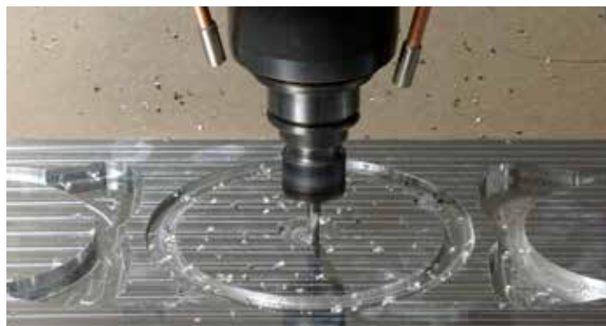
Ricavati da blocchi di pieno di alluminio aeronautico i gusci del diffusore vengono assemblati in una struttura che risulta particolarmente inerte.
